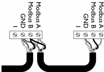
Kommunikation verwendet und eine Ader des anderen Paares dient als Masseanschluss.
